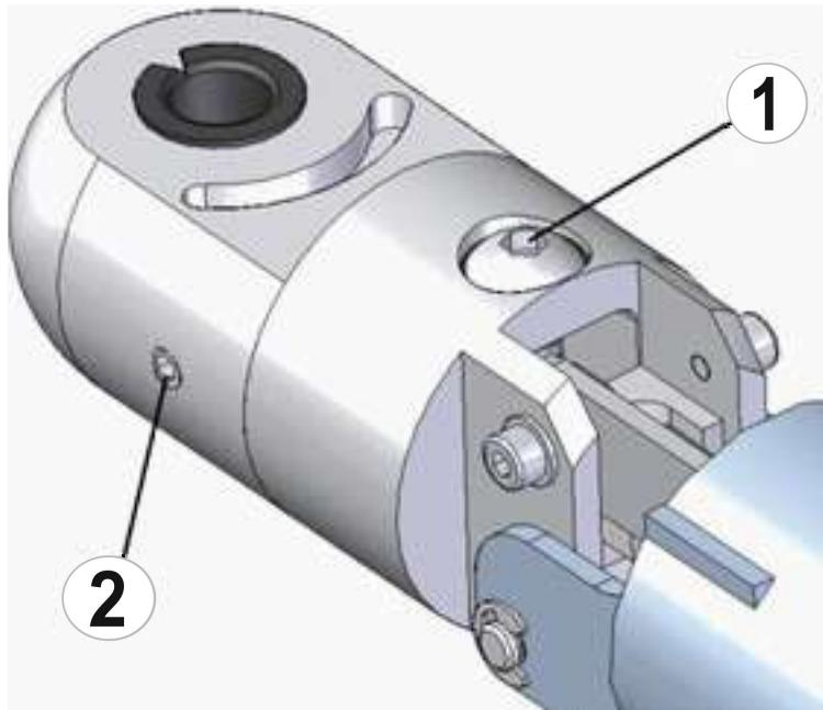
Mit der Einstellschraube lässt sich das Tray in seine radial-waagerechte Position ausrichten.
