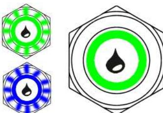
Durch einen Doppelklick am Taster wird die Intensivspülung aktiviert. Taster der WTE leuchtet konstant blau während der Phase der doppelten Dosierung. Taster der WTE grün-blau-blinkend. Nachspülen aktiv.
