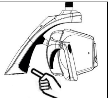
Wenn die Raumleuchte mit der Dentallampe synchronisiert ist, leuchtet die blaue LED an der Raumleuchte konstant. Wenn die LED erlischt, bedeutet dies, dass die Synchronisierung nicht aktiv ist.
